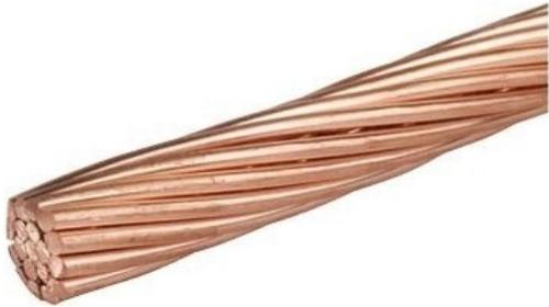
Secção transversal 50 mm<sup>2</sup>, Diâmetro externo 9 mm, Quantidade de fios individuais 19, Diâmetro dos fios individuais 1,8 mm, Material Cobre, Proteção de superfície sem tratamento, Material do revestimento sem, Peso 44 kg/100 m
