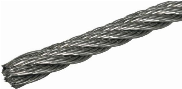
Secção transversal 42 mm<sup>2</sup>, Diâmetro externo 10 mm, Quantidade de fios individuais 133, Diâmetro dos fios individuais 0,68 mm, Material aço inoxidável, Proteção de superfície sem tratamento, Material do revestimento sem, Peso 39,5 kg/100 m
