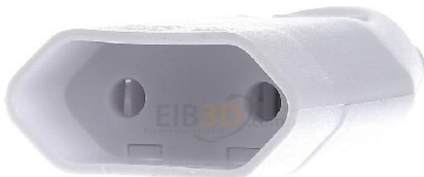
Versão outro, Material Plástico, Qualidade do material Termoplástico, Sem halogénio não, Tipo de proteção (IP) IP20, Direção de encaixe direito, Tecnologia de conexão Borne roscado, Adequado para pino de contacto de proteção sim, Cor branco, Número RAL 9010, Tensão nominal 250 V, Corrente nominal 16 A, Para "condições difíceis" (conforme VDE) não
