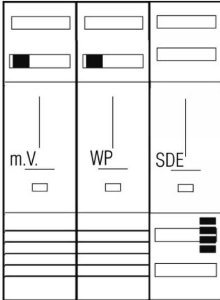
**Espaço de balcão completo 3pt. 1Z 1WP 1TSG 1V3 o.SH - Painel de medição 1 kWh-meters 3 rows Z37E914N**
