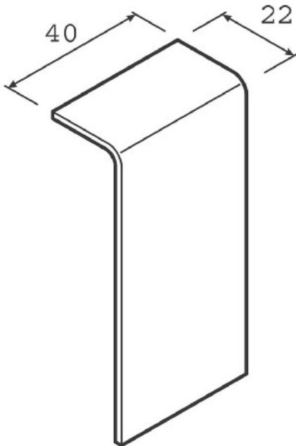
**Laminação - Acoplador para duto de contorno 80x20mm
