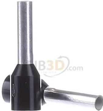
Modelo de construção Normalizado, Secção transversal nominal 1,5 mm<sup>2</sup>, Comprimento da manga 8 mm, Isolado sim, Material do isolamento Polipropileno (PP), Sem halogénio sim, Cor preto, Material Cobre, Proteção de superfície estanhado, Para cabos à prova de curto-circuito não, Com patilha de identificação não, Acondicionamento em bobina não
