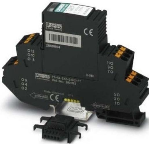
Tensão nominal DC 24 V, Tensão contínua máxima AC 21 V, Tensão contínua máxima DC 30 V, Corrente de pico de descarga nominal (8/20) 10 kA, Corrente de carga nominal 0,7 A, Limiar de proteção filamento/terra 55 V, Frequência limite 1,1 MHz, Tipo de montagem outro, Ligação 1 Terminal, Monitorização de descarga sim, Com contacto de detetor remoto não, Sinalização no aparelho ótico, Versão testada quanto a explosões não
