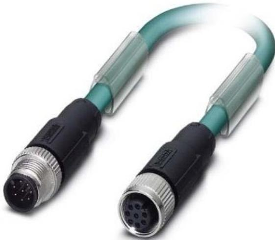
Número de polos 8, Disposição do cabo de alimentação, lado do campo outro, Comprimento do cabo 5 m, Material da blindagem do cabo outro, Sem halogénio não, Cor da blindagem do cabo outro, Com indicador LED não, Blindado sim, Tipo de cabo multi-filamentos, Material da unidade base de contacto outro, Corrente nominal In 2 A, Tensão nominal 30 V, Tipo de proteção (IP) IP65
