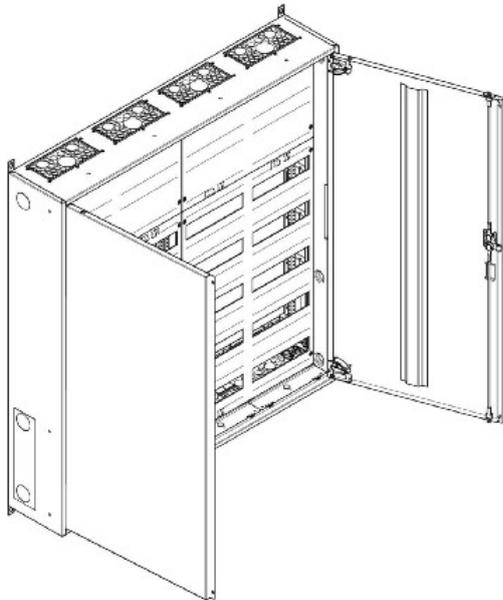
**Caixa de parede IP43 SK2 - Gabinete de distribuição
