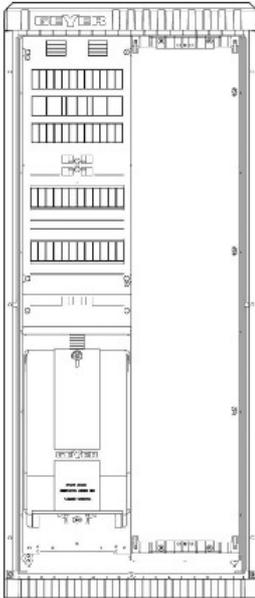
**Gabinete de conexão do medidor SAS APZ 5pol -
