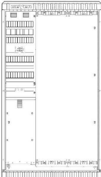
**Gabinete de conexão do medidor SAS APZ 4pol -
