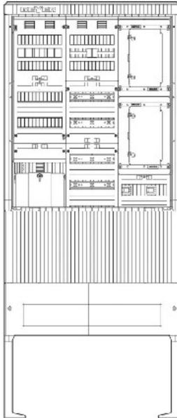
**Coluna de conexão do medidor 2 ZPvert.5R APZ 5pol -
