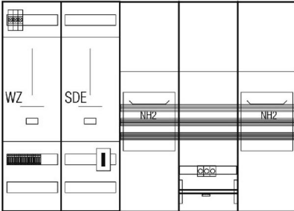
Corrente nominal 320 A, Versão 1 piso, Quantidade de posições de contagem 1, Sala de conexão inferior com barra coletora, Tipo de montagem Montagem à superfície, Material Chapa de aço, Quantidade de linhas de distribuição 2, Quantidade de campos 5, Com placa de montagem não, Tipo de proteção (IP) IP43, Largura 1300 mm, Altura 950 mm, Profundidade 210 mm, Largura de instalação 1250 mm, Altura de instalação 900 mm, Profundidade de instalação 200 mm
