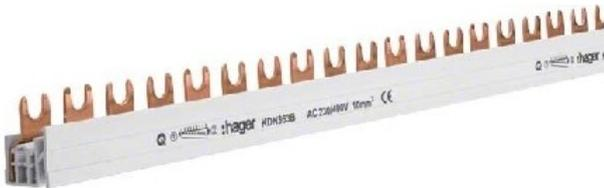
Quantidade de fases 3, Número de polos 3, Adequado para quantidade de aparelhos 14, Medida de divisão 17,8 mm, Secção transversal 10 mm<sup>2</sup>, Comprimento 1000 mm, Largura em unidades de divisão 57, Corrente contínua nominal Iu 63 A, Versão da ligação elétrica Garfo, Isolado sim, Tensão nominal de pico 4,5 kV, Tensão operacional nominal máx. Ue 400 V, Adequado para aparelhos com cabo N não, Adequado para aparelhos com interruptor auxiliar não, Cor cinzento
