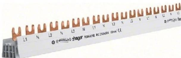
Quantidade de fases 2, Número de polos 4, Adequado para quantidade de aparelhos 54, Medida de divisão 17,8 mm, Secção transversal 16 mm<sup>2</sup>, Comprimento 1000 mm, Largura em unidades de divisão 54, Corrente contínua nominal Iu 80 A, Versão da ligação elétrica Garfo, Isolado sim, Tensão nominal de pico 4,5 kV, Tensão operacional nominal máx. Ue 400 V, Adequado para aparelhos com cabo N sim, Adequado para aparelhos com interruptor auxiliar não, Cor cinzento
