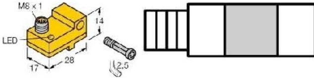
Tipo de acionamento Íman, Versão da saída de comutação PNP, Largura do sensor 17 mm, Altura do sensor 14 mm, Comprimento do sensor 28 mm, Modelo de construção da caixa Cubo, Material da caixa Plástico, Temperatura ambiente -25..70 °C, Tensão de alimentação nominal em DC 10..30 V, Tipo de tensão DC, Possibilidade de deteção de circuitos cruzados/curto-circuitos sim, Tipo de proteção (IP) IP67
