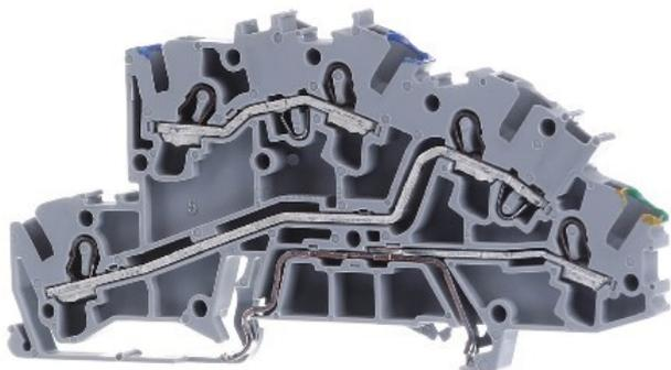
Corrente nominal In 32 A, Tensão nominal 400 V, Quantidade de potenciais 3, Tipo de montagem Trilho DIN TH35, Material da unidade de isolamento Termoplástico, Temperatura operacional 105 °C, Largura 5,2 mm, Altura 96 mm, Profundidade 42,3 mm, Necessita de placa terminal sim, Cor de fundo cinzento, Com função PE sim, Com terminal de terra N não, Possibilidade de função N sim
