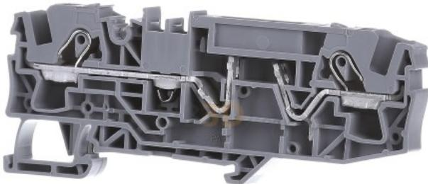
Versão da aplicação de segurança Fusível plano, Versão do suporte de segurança pode ser acoplado, Corrente nominal In 25 A, Tensão nominal 500 V, Quantidade de pisos 1, Tipo de montagem Trilho DIN TH35, Material da unidade de isolamento Termoplástico, Temperatura operacional 105 °C, Largura 7,5 mm, Altura 96,3 mm, Profundidade 32,9 mm, Necessita de placa terminal sim, Cor cinzento
